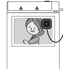
光センサーを貼り付けた液晶画面が消えているときに学習ボタンを3秒以上6秒未満長押ししてください。学習ランプが点滅したら長押しをやめてください。光センサーが設置環境の明るさを学習し、センサー感度が最適化されます。
