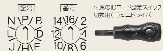
**重要** 本製品には、電波の混信を避けるため256通りのIDコードがあります。初期設定[P-16]で使用すると、ご近所の方が同じXPシリーズを購入された場合、混信する恐れがあります。混信を避けるためには、必ずお客様独自のIDコードに設定してください。
