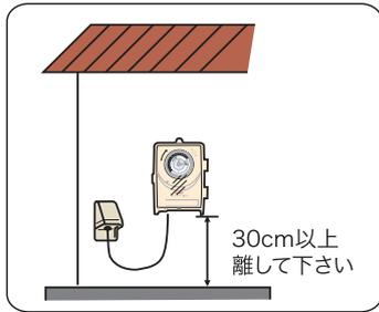
垂直な面に、コンセントを下向きにして取り付けます。本体のカバーを開け、2本の木ネジで本体をしっかり固定してください。(左図参照)
