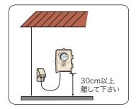
垂直な面に、コンセントを下向き にして取り付けます。本体のカバーを 開け、2本の木ネジで本体をしっかり 固定してください。(左図参照)
