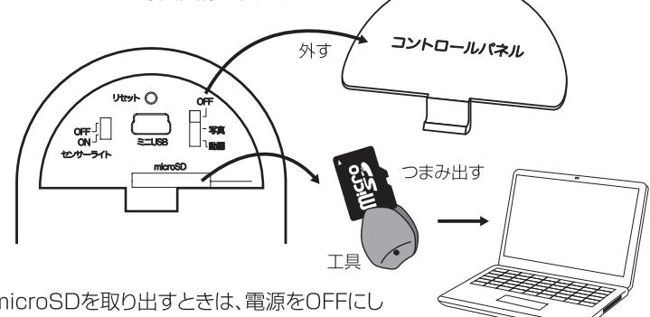
microSDを取り出すときは、電源をOFFにしmicroSDを1度カチッと押し込み、とび出させてから、付属の工具を使ってつまみ出してください。
