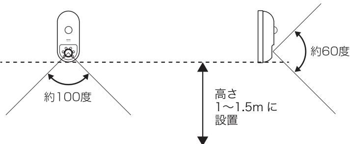
《ご注意》 カメラに対して横切る方向に動く対象物は、センサーに反応して撮影がスタートするまでにカメラの前にいない場合があり、撮影されないことがあります。この場合カメラの取付け位置や向き、角度を変えていただくことをおすすめします。
