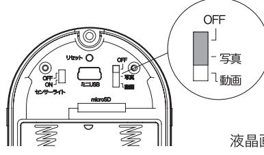
3) 電池BOX蓋を開け、新品の単3形アルカリ乾電池3本を(+)(-)の向きを間違えないようにセットします。
