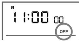
本機を「OFF」にすると、電気器具が動作しない
