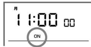
本機を「ON」にすると、電気器具が動作する
