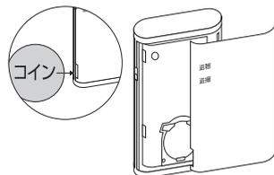
本体ケース側面にある溝にコインを挿し込み、カバーをこじ開けます。
