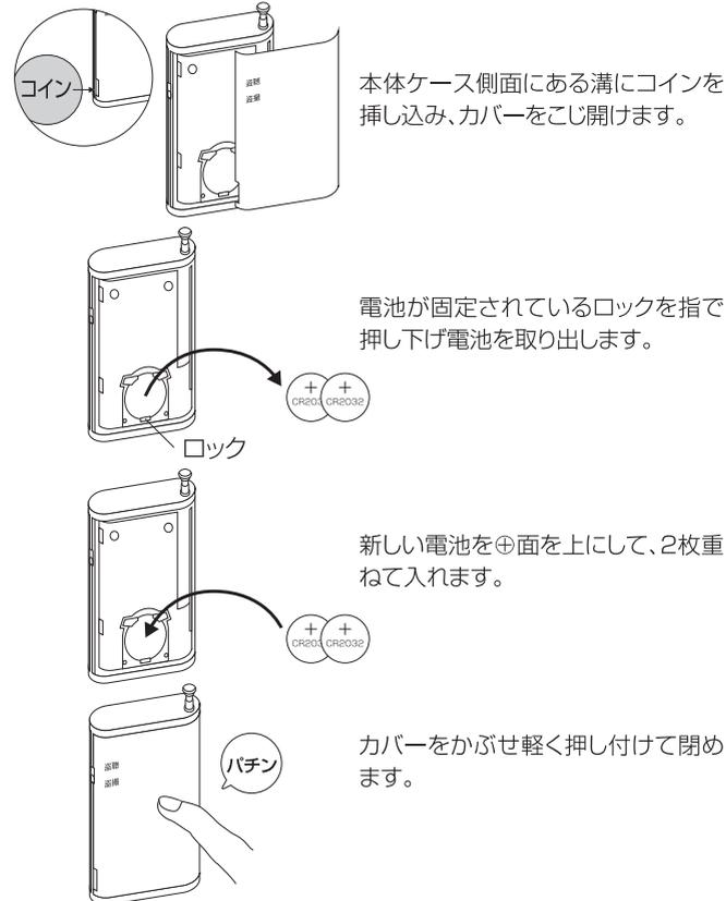
※電池交換したら、必ず電源を入・切して動作確認をしてください。
