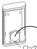
電池が固定されているロックを指で押し下げ電池を取り出します。
