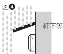
④屋外に設置する場合は、直接雨のかからない軒下等に設置してください。また、風雨に煽られて落下しないよう取付プレートをしっかりと固定してください。
