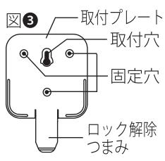
③引っかける場合は中央のネジ受けを利用。固定する場合は3カ所の穴を壁面にネジ止めしてください。ネジが効かない外壁面には、付属の樹脂リブを使用してください。（下穴を開け、樹脂リブを打ち込み、樹脂リブにネジをねじこみます。）
