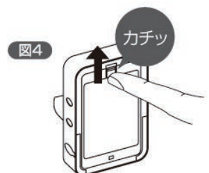
電池蓋ロックを指先で引っかけて押し下げて引く。
