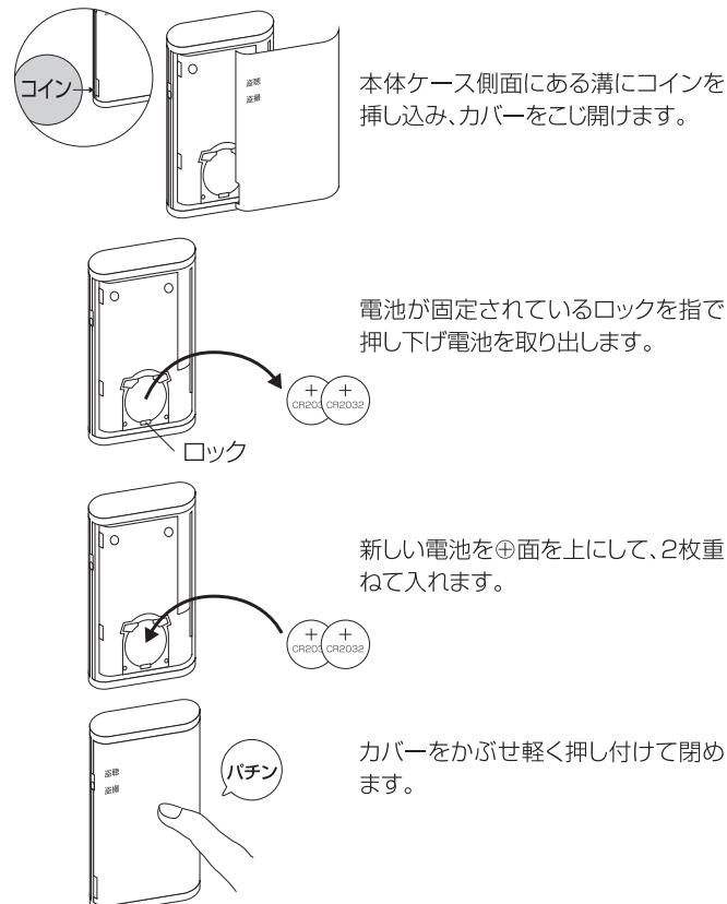
※電池交換しましたら、必ず電源を入れ・切して動作確認をしてください。
