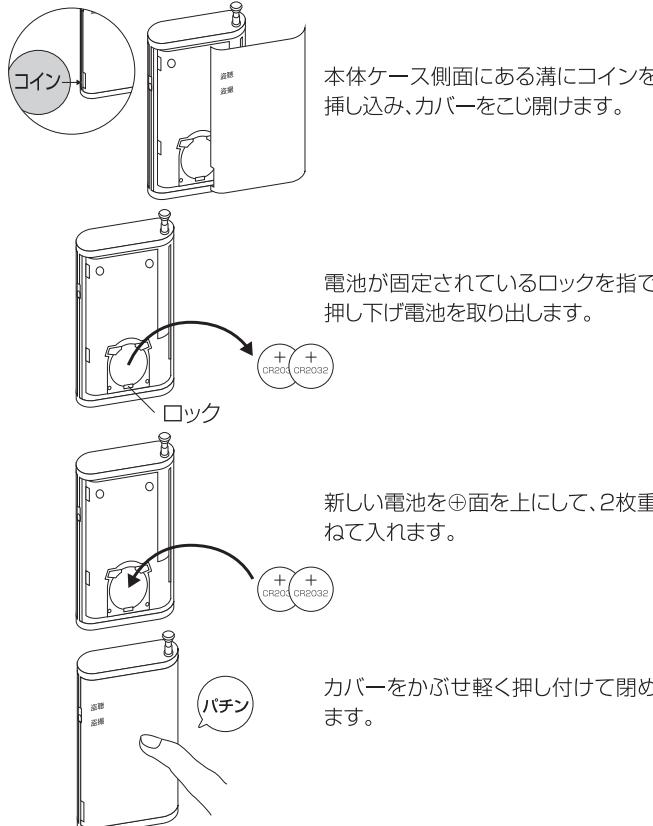
※電池交換しましたら、必ず電源を入・切して動作確認をしてください。
